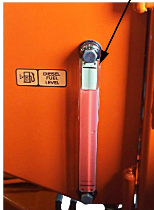
Nivel del combustible diésel
