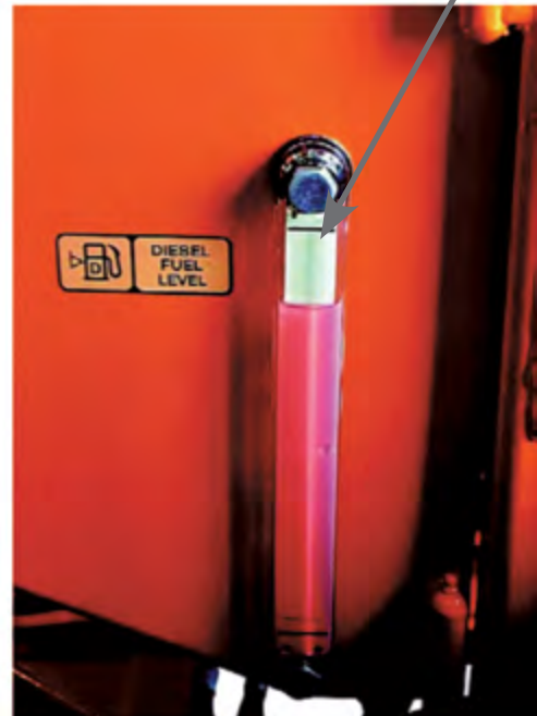
Nivel del combustible diésel
