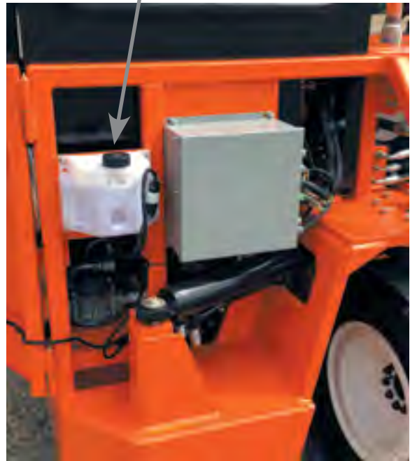
Nivel de fluido de la lavadora
