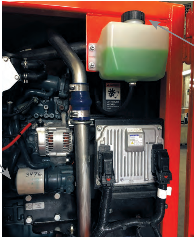
Comprobar el nivel de líquido refrigerante
