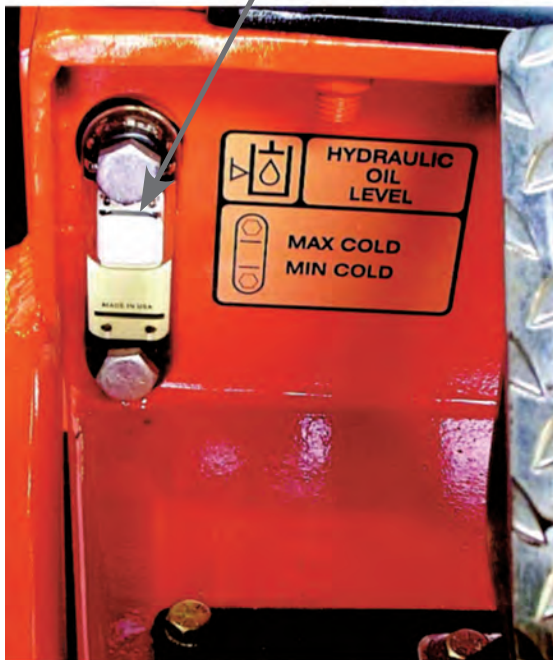
Nivel del fluido hidráulico
